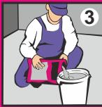
Для подготовки раствора залейте водопроводную воду комнатной температуры в чистую ёмкость из расчёта 5,0-6,0 л на 1 мешок (25 кг).
