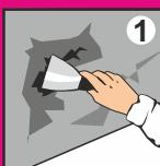
Подготовьте основание, удалите с него ослабляющие скрепление вещества: масляные и битумные пятна и прочие загрязнения. Отслаивающиеся участки удалите стальным шпателем. При оштукатуривание фасадов наружную гидроизоляцию и установку водоотводящих систем выполните до начала работ.
