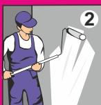
Обработайте основание грунтовочными составами БОЛАРС, соответствующими Вашему типу поверхности.
